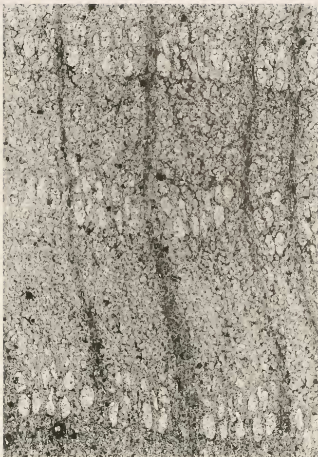
Abb. 11. Quercoxylon sp., Eiche, Fundort Großmuß. – Querschliff mit drei Zuwachsgrenzen, großen Frühholzgefäßen und breiten Holzstrahlen, Grundgewebe weitgehend zerstört. x 15.
